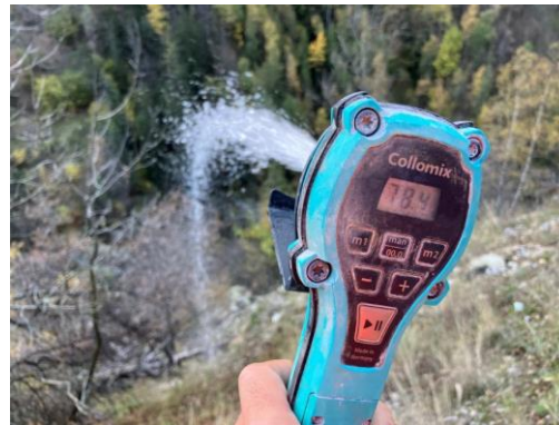
Abb. Nr. 10: Überprüfung/Funktionskontrolle der Wasserdosierung
