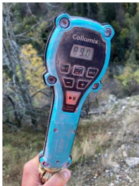
Abb. Nr. 9: Einstellen der Wassermenge
