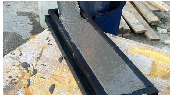
Abb. Nr. 14: Giessen eines Biegezugbalken
