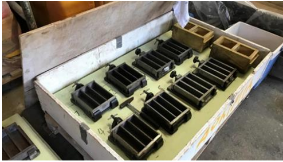
Abb. Nr. 13: Würfel- und Prismenschalungen
