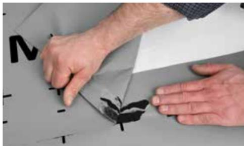
Vor Beginn der Schweissarbeiten ist eine Probeschweissung mit Schältest (längs oder quer) durchzuführen. Nach dem Schweissvorgang die Naht optisch auf offene Stellen prüfen.
